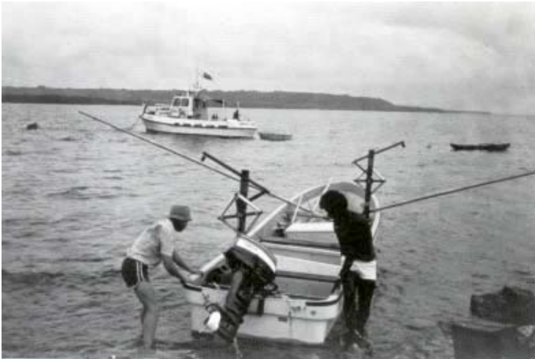
Tangons de traîne en fibre de verre montés sur un canot japonais Photo prise à Espiritu Santo (Vanuatu), par L. B. Chapman
